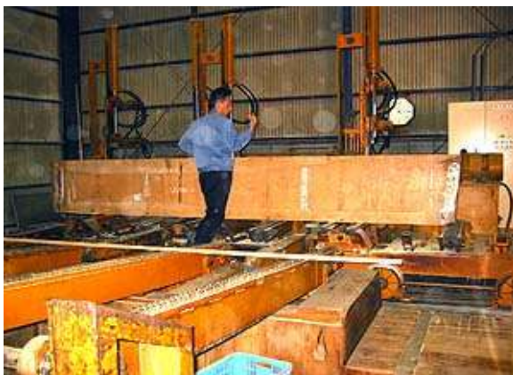
左記の写真は米ヒノキのカウンター材を製材で反りを直している所です。 これが味吉兆のカウンターになった材です。
